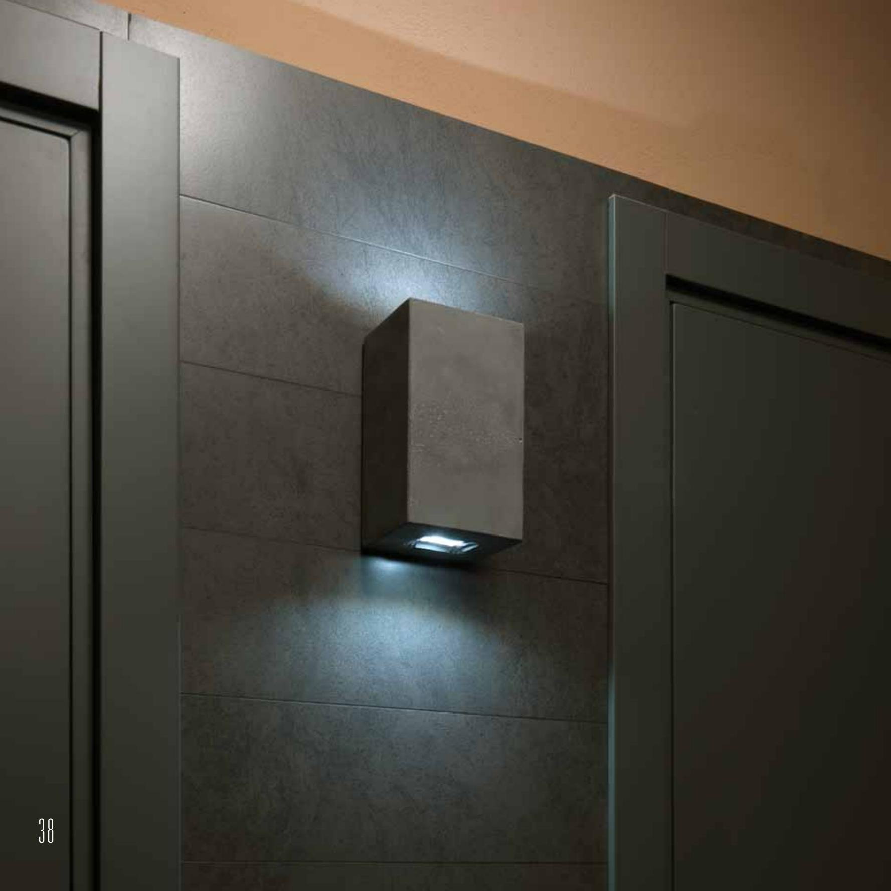
Apparecchio da parete per illuminazione di interni ed esterni con sorgenti LED, disponibile in versione mono-emissione e bi-emissione. Corpo in VFRC (vinilic fiber reinforced concrete) con finitura "cemento lisciato" realizzata a mano. Gruppo ottico in alluminio completo di sorgente LED da 8/16W (720/1480 lumen alimentati a 500mA), alimentazione elettronica integrata 50/60 Hz 120/240V, piastra di montaggio in acciaio per il fissaggio a parete. Grado di protezione IP65.
